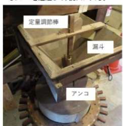
豆・米を粉砕する挽臼。漏斗の上から穀類を投入し、粒は挽臼と一緒に回るアンコを通して、挽臼に入る。
