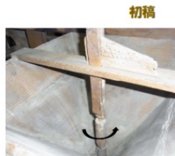
初稿 調節棒 回転し ながら 揺れる 漏斗 排出孔 すき間から穀物落下。すき間の大きさは調節棒の上下で調節
