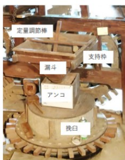
豆・米を粉砕する挽臼。漏斗の上から穀類を投入し、粒は挽臼と一緒に回るアンコを通して、挽臼に入る。
