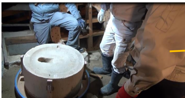
上臼の周りに4つの引き木（臼歯車と上臼を繋ぐ部品）を配置し、臼歯車を装着。回転は反時計回り。
