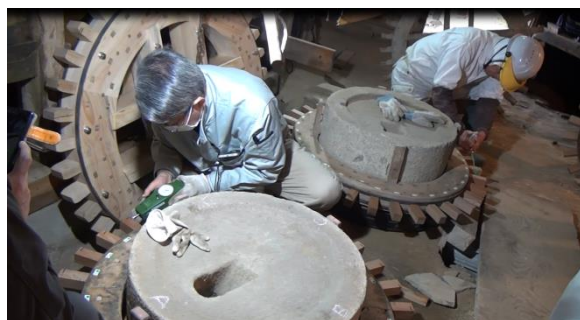
早速、バネ秤でなにやら計測？上臼がどの程度の力で回り始めるかチェック！
