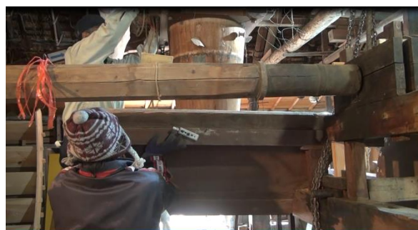
ガンド（篩）へ通じる回転軸の作動状況を点検中 池森先生と友の会。
