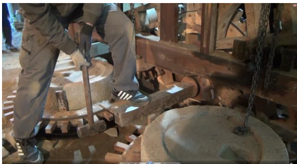
水車の心棒を打ち込み、楔で締め付ける作業。
