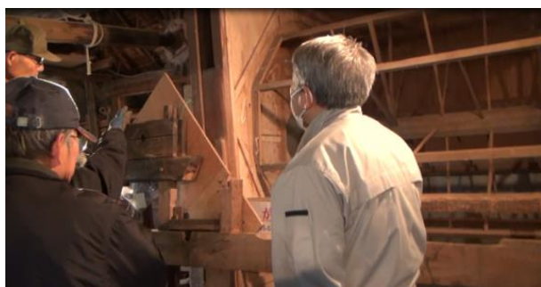
ガンド（篩）へ通じる回転軸の作動状況を点検中 池森先生と友の会。
