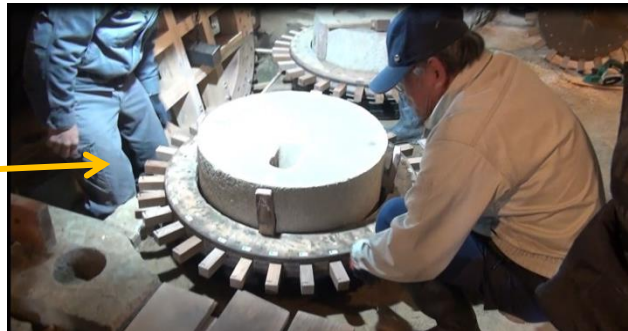
上臼の周りに4つの引き木（臼歯車と上臼を繋ぐ部品）を配置し、臼歯車を装着。回転は反時計回り。
