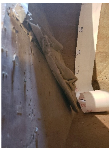
四角漏斗の内側に残る布の 切れ端
