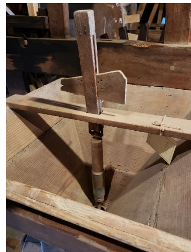
二番石臼用四角錐漏斗の内側 (中央は落下量調節器)
