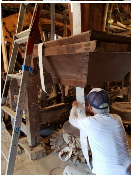
長い漏斗の容量の測定 (手作りの 紙物差し利用) 2020.6.27
