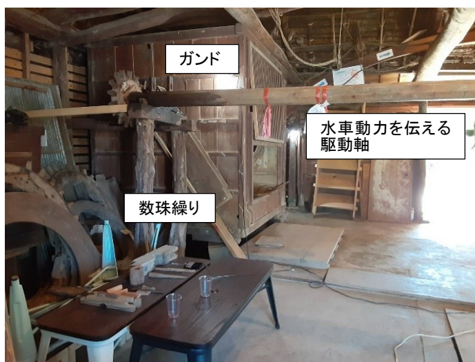
水車の動力を伝える駆動軸が部屋の中央を水平に横切 っている。この軸が数珠繰り (搬送装置) を動かし、 ガン ドと連動して回転する。
