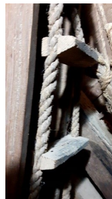
残っている数珠繰りの綱と小板のコマ (ガン ド出口から長い漏 斗までのもの)
