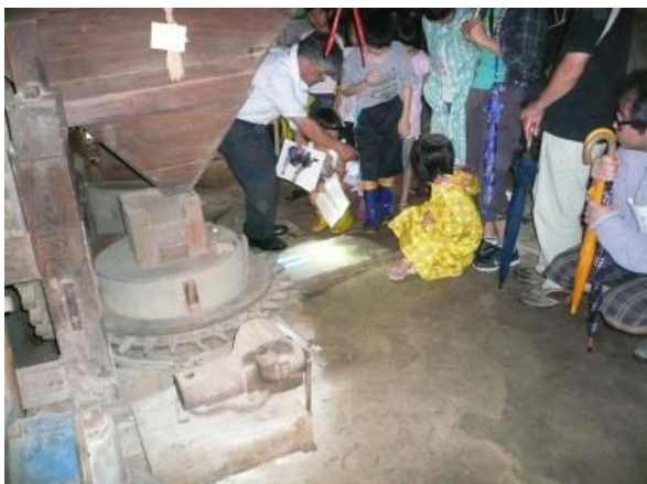
「石臼で碾かれた粗い粉が、この下を木製のコンベアーのようなもので送られていきます」
